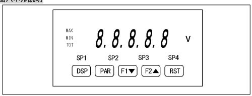
キー表示モード操作プログラムモード操作DSP 表示項目選択--- MAX,MIN,Total,読み<br/>PAR パラメータアクセス<br/>F1 No.1ファンクションキー3 秒後変更<br/>F2 No.2ファンクションキー "選択パラメータ格納、次のPAR 索引<br/>パラメータ値を増加させる<br/>パラメータ値を減少させる<br/>F1,F2 値を 1000 倍までスクロール
