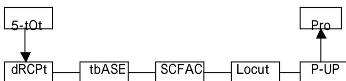
トータライザーは下記2つのモードのいずれかを用い入力値を積算します。第1モードでは時間ベースで流量及びその積算に用いられます。第2モードはキーもしくはユーザー入力によるバッチ式積算用にプログラムされ、1業務完了ごとの計量に用いられます。トータライザーを用いないときは、この表示をロックアウトできます。
