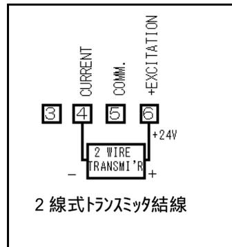
⚠ センサー入力 common とユーザー入力 common とは絶縁されていないので、相互結線をしないでください。24VDC 電源は、トランスミッター励起用以外に使用しないでください。
